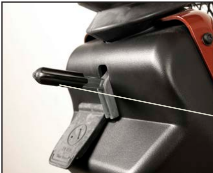
Einstellen der Lenksäulenneigung
