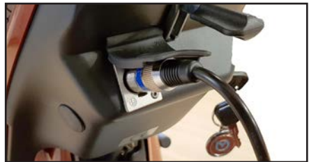
Der Ladestecker wird an die 3-polige Ladebuchse an der Lenksäule angeschlossen. Die Ladebuchse befindet sich unter der Schutzklappe.
