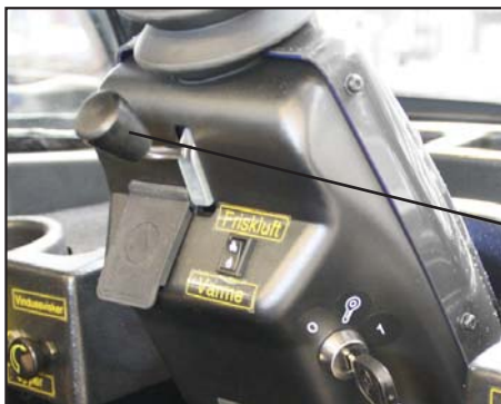
Einstellen der Lenksäulenneigung
