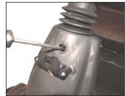
Einstellen der Lenksäulenneigung
