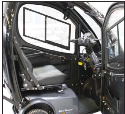
Mini Crosser ausschalten, Lenksäule nach vorne schieben und Armlehne hochklappen.
